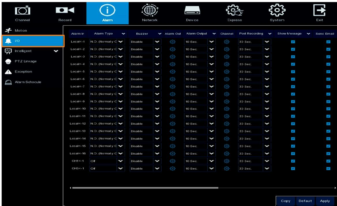
**Тревожные Входы:** Отображение номера входа. Локальные: подключенные к NVR N. CH: подключенные ко входам IP камер.
