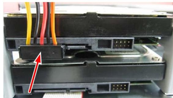
4. Установите HDD на посадочные места как показано на рисунке и закрепите винтами из комплекта.
