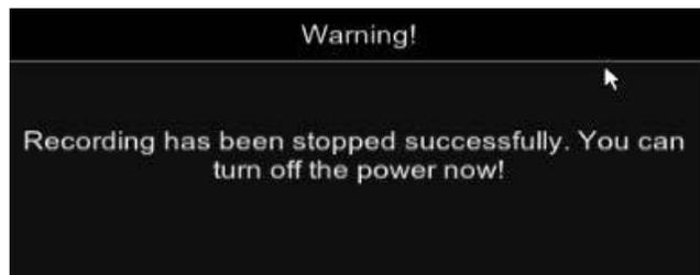
После нажатия кнопки **Shutdown**, появится окно предупреждения. После этого можно отключить питание на задней панели NVR.
